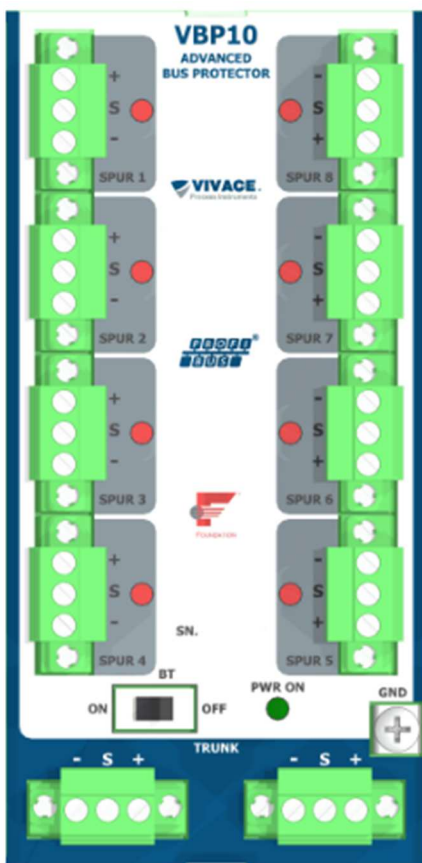
Figura 5.1 – Etiqueta de identificação do VBP10 (modelo de 8 canais).
